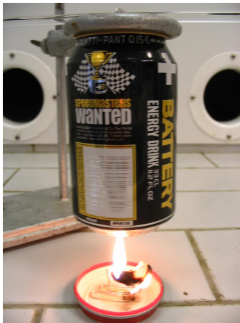
Kuva 5.10. Tutkimuslaitteisto. Tutkittavana cashewpähkinä
