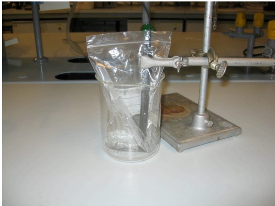
Kuva 1. Kokeen työjärjestelyt: Statiivi, koura, keitinlasi ja suljettava muovipussi, jonka sisällä koeputki ja pipetti.
