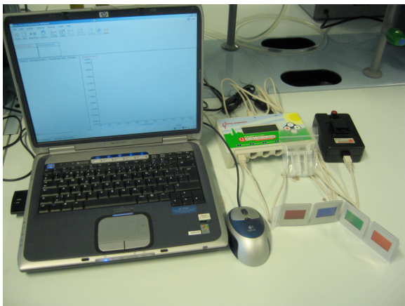
Kuva 1. Mittausautomaatiolaitteisto ja kolorimetrisessä analyysissä tarvittavat välineet.
